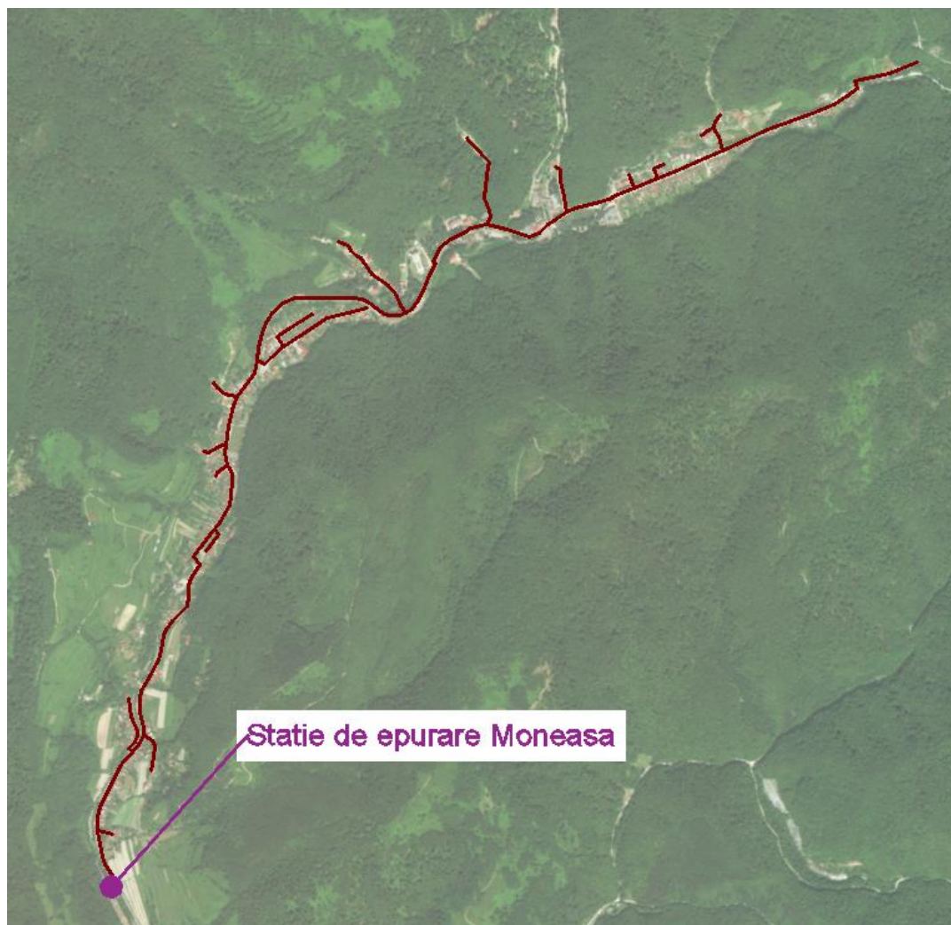
Figura 4.168. Infrastructura de apa uzata Moneasa.
