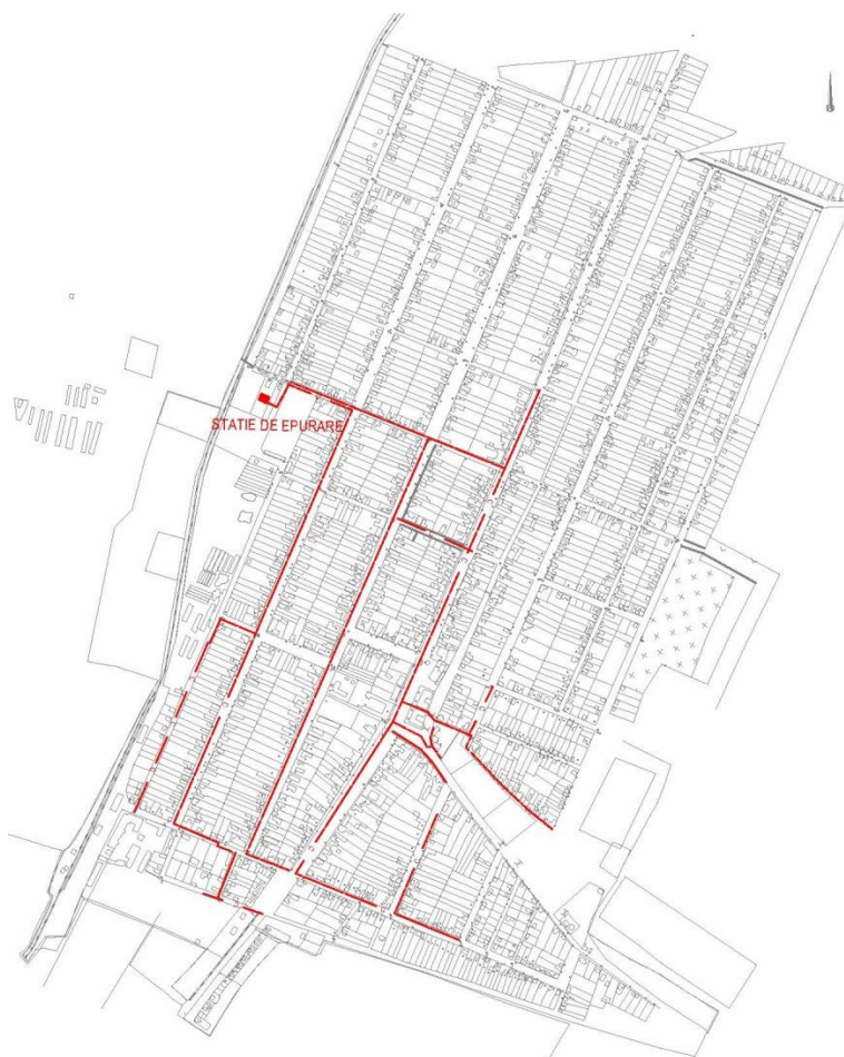
Figura 4.195. Plan general retea de canalizare oras Pancota (rosu - colectoarele de canalizare).
