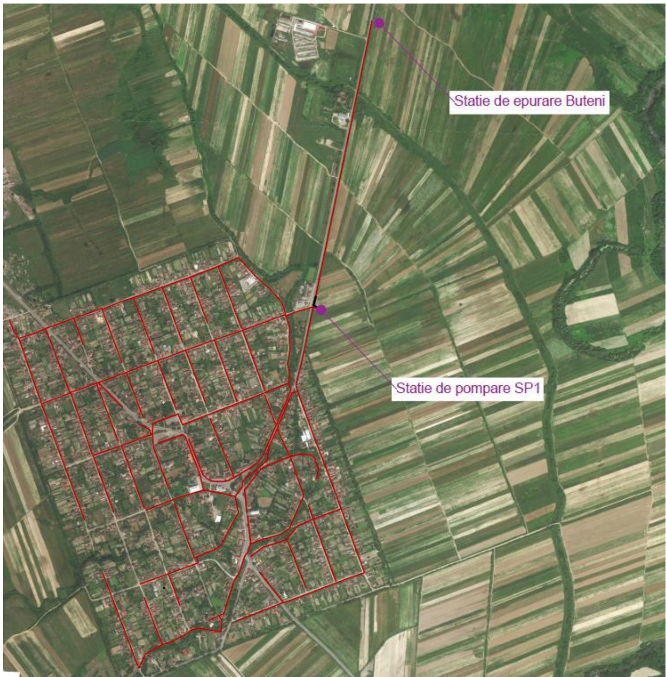
Figura 4.170. Infrastructura de apa uzata Buteni Maro – retea de canalizare, Negru – conducte de refulare.
